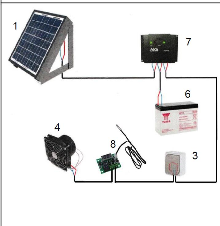
La batterie (6) et le panneau photovoltaïque sont branchés sur le régulateur (7). Celui-ci charge la batterie le jour, jusqu'à sa valeur maximale à partir de laquelle le régulateur coupe la charge.
